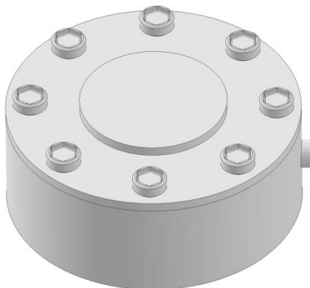
图 6 轮辐式传感器装配图
